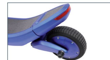
Gefederte Hinterradschwinge Antriebsrad mit Nabenmotor
