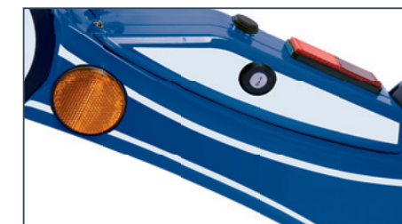
Spritzwassergeschütztes Akkufach mit Zündschloss und Ladebuchse
