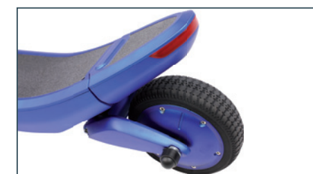
Gefederte Hinterradschwinge Antriebsrad mit Nabenmotor
