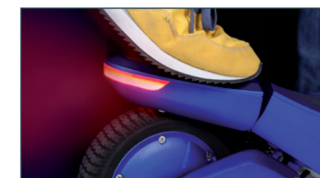
Rücktrittsbremse mit integriertem Bremslicht
