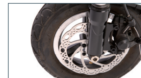
Scheibenbremsen vorn und hinten
